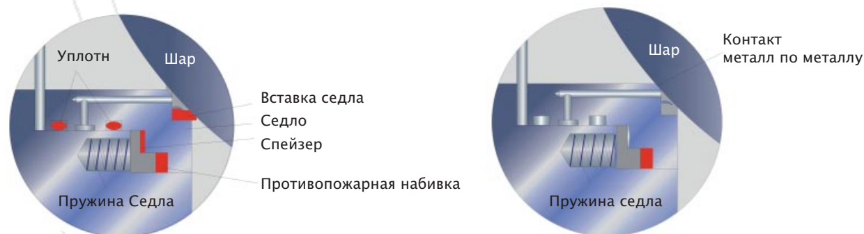
Рис. 1a Седло клапана до испытания на пожаробезопасность Рис. 1b Седло клапана после испытания на пожаробезопасность
