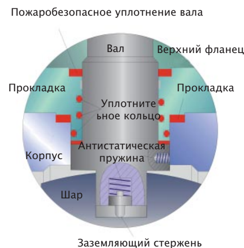
Рис. 3 Аварийная система уплотнений
